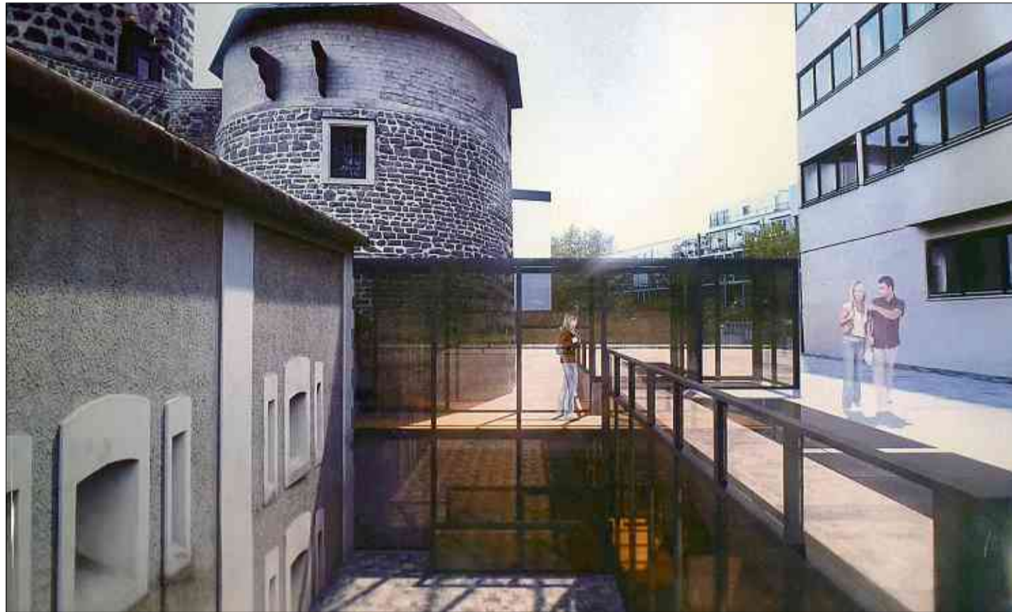
Ein Lichthof erlaubt die Nutzung von unterirdischen Räumen, die zum Nachbarhaus (rechts) und zur Straße (hinten) liegen.
